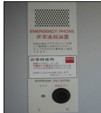
車両連結部 非常通報装置
